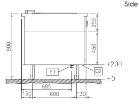
Electrical inlet (power) EQ **Equipotential screw** Water inlet
